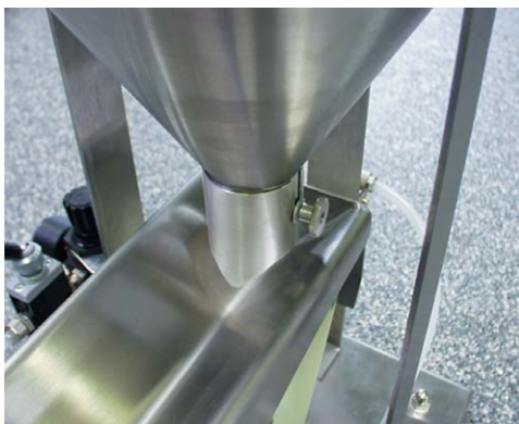
Dispositif de dosage à la sortie du réservoir
